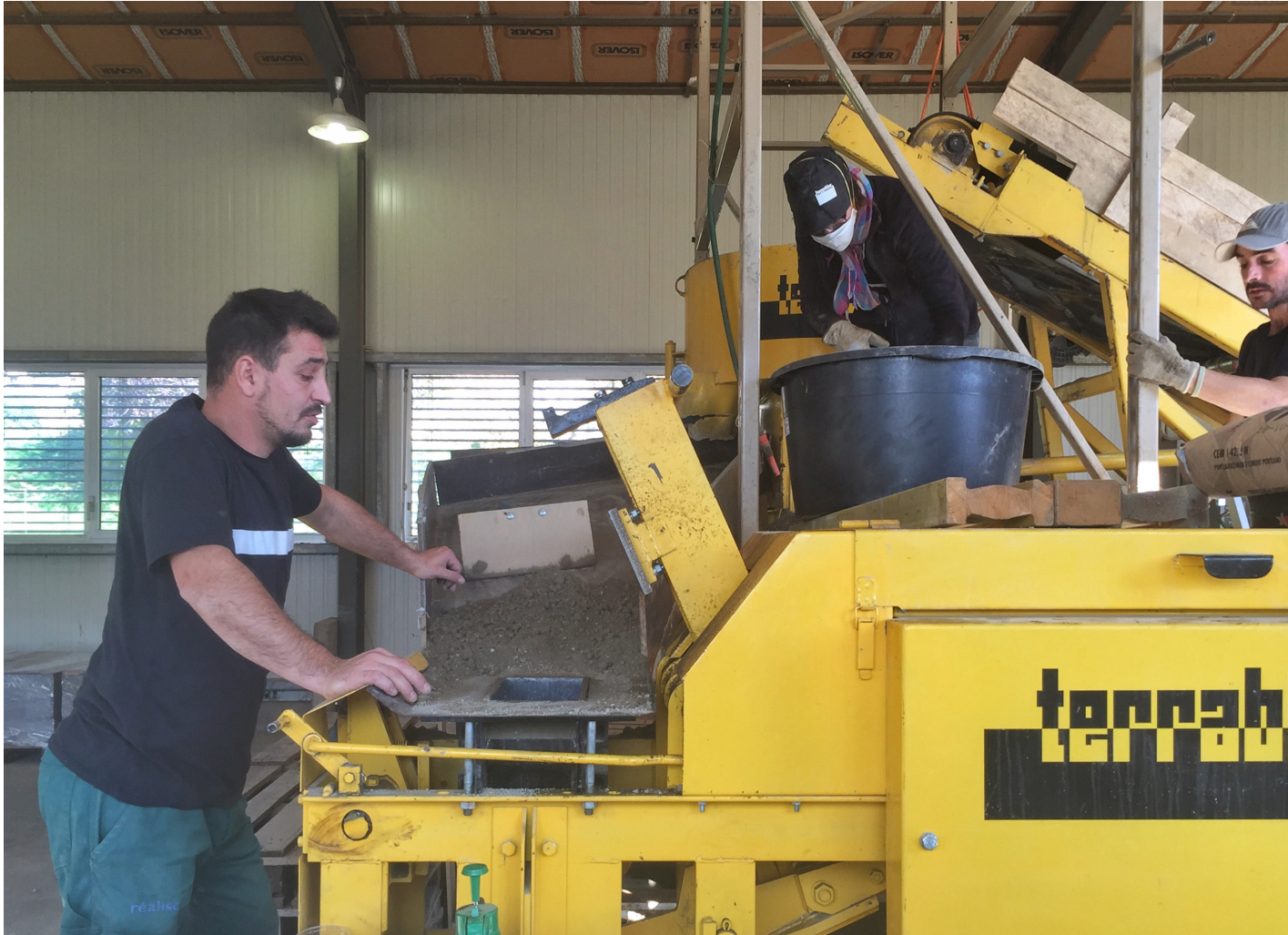
FABRICATION MANUELLE DES BRIQUES DE TERRABLOC 2015
